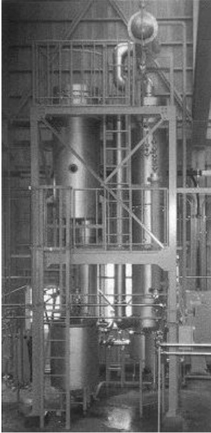
左図はリンゴ果汁の芳香回収装置です。原果汁の約1/10量を液膜流下型蒸発缶で蒸発させ、精留塔を兼ねた表面凝縮器で蒸発蒸気の一部を凝縮し、残余の芳香成分の多い蒸気を充填塔へ供給します。充填塔で精留を行い、芳香成分を多量に含んだ原果汁の1/200~1/500量の製品を回収します。スクラバで凝縮器出口のガスを洗浄し、大気中への芳香成分の逸散を少なくします。
